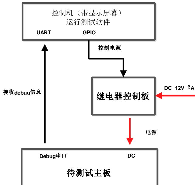
如上图所示，采用一台稳定的控制机，运行测试软件，对待测主板进行反复上下电测试，同时监控调试串口有指定的字符串返回，比如开机进入 linux 系统后会发送一串信息，此时表示启动完成，如果在一定的时间内（比如 30 秒）没有收到，表示启动失败。
